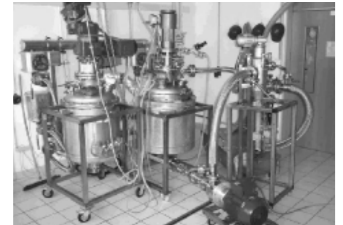
Lösereaktor, Kantenspaltfilter und Fällreaktor zum Rezyklieren von Kunststoffen im explosionsgeschützten Labor im Fraunhofer IVV.
