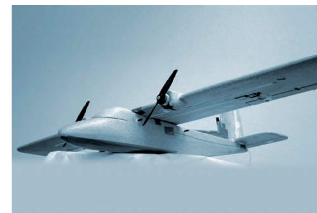
Carolo T140, Prototyp zur Flugreglerentwicklung, erster vollautomatischer Flug 2004
