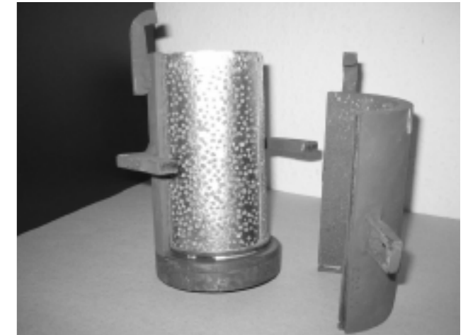
Mineralschaumverbundwerkstoff mit Aluminiummatrix
