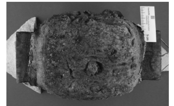
Bild 2: Probekörper nach einem Brandversuch
