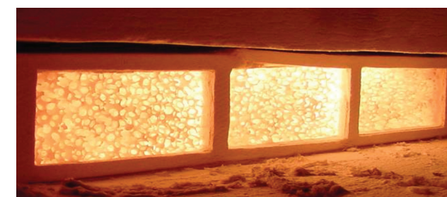
Porenbrenner in Betrieb
