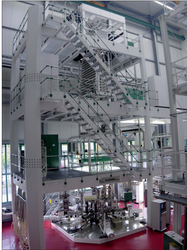
Bild 2: Blasfolienanlage im Technikum der Kuhne GmbH
