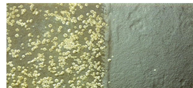
Abb. 2: Antifoulingwirkung an einem Schiffskörperausschnitt, links ohne Stromfluss und rechts bei elektrochemischer Behandlung
