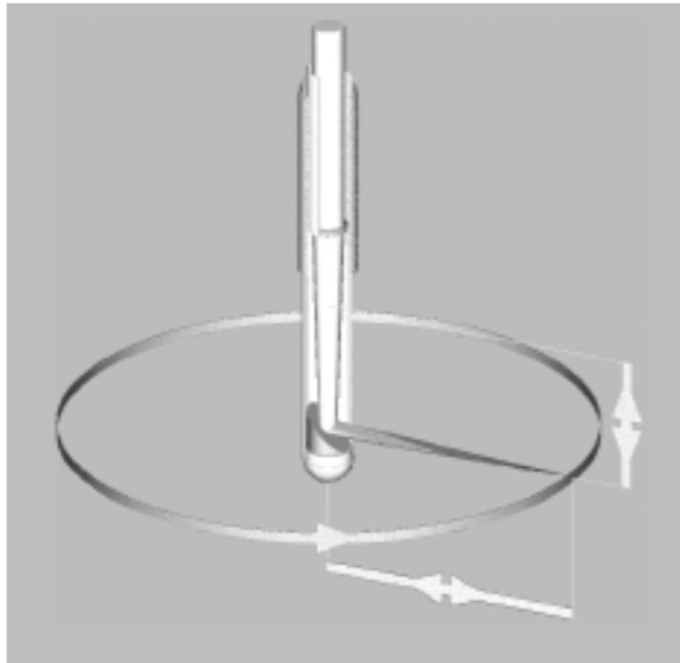
Prinzipische Skizze zur Bewegung der Lasersonde in drei Dimensionen: Rotation, Translation, Fokusslageverstellung Quelle: Firma MRC-Systems
