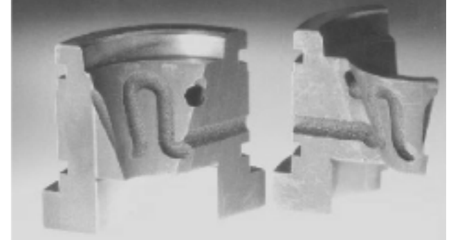
Mit Laserschmelzen hergestellter Formeinsatz aus Werkzeugstahl (1.2343) mit integriertem konturangepassten Kühlkanal.
