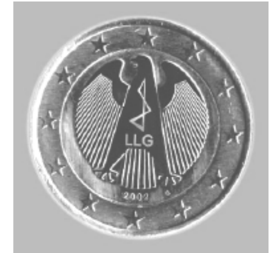
Mit einem UV-Femtosekundenlaser hergestellte lichtbeugende Struktur auf einer Euro-Münze
