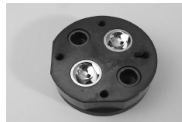
Bild 1: Formeinsatz für das Präzisionsblankpressen konvex gekrümmter Glaslinsen (Quelle: Toshiba)
