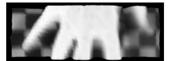
Abbildung 2: Intensitätsbild Hand vor Schachbrett: Die Bildpunkte geben die Intensität des rückgestreuten Lichts wieder. Die Hell-Dunkel-Struktur des Schachbretts ist sichtbar.
