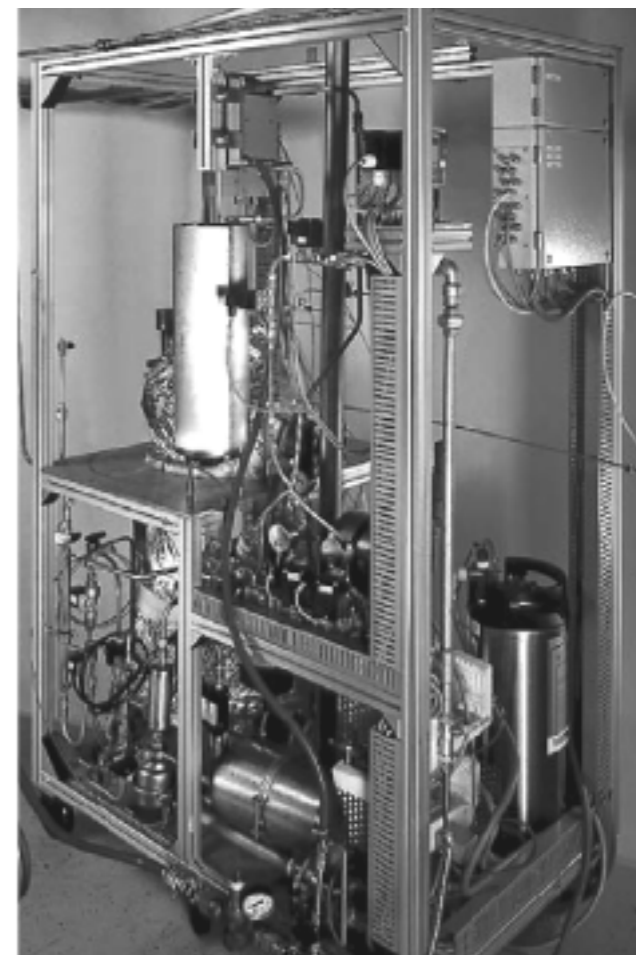
Abb. 1: Erdgasreformer mit einer elektrischen Leistung von 2 kW entwickelt und aufgebaut am Fraunhofer ISE
