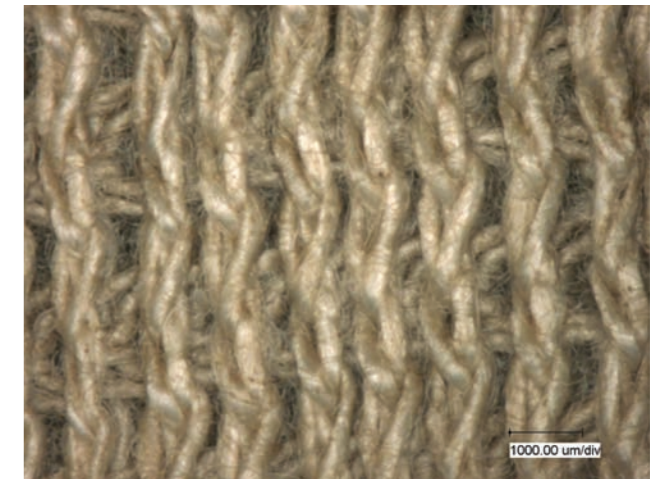
Abb. 1: Mikroskopaufnahme eines mit einem photoaktiven solvothermalen TiO 2 -Nanosol beschichteten Viskose-Gestricks (Machbarkeitsstudie)
